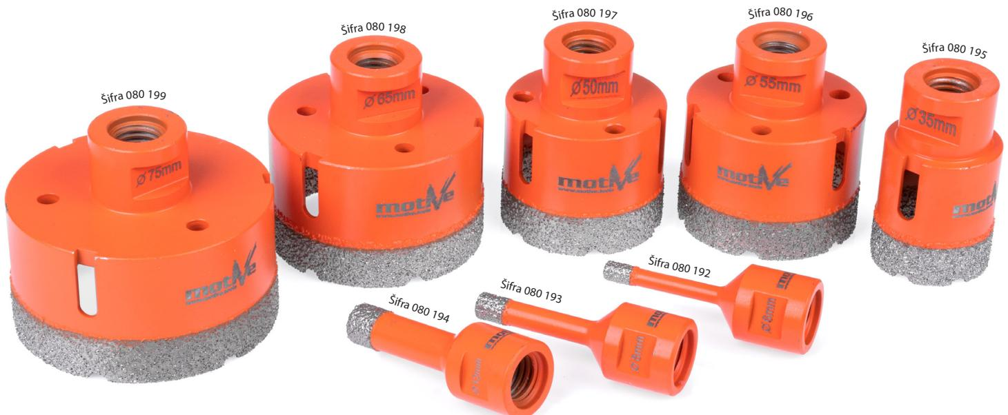
Dijamantski vrh za brzo sečenje ostavlja manje prašine. Idealne su za bušenje porcelana, mermera i granita. Maksimalni broj obrtaja 12200 ob/min. Na početku bušenja, postavite krunu pod uglom od 45°, pa kada se kruna (rupa) pokrene, vratite na 90°. Nastavite sa bušenjem ali krećite se kružnim pokretima.
